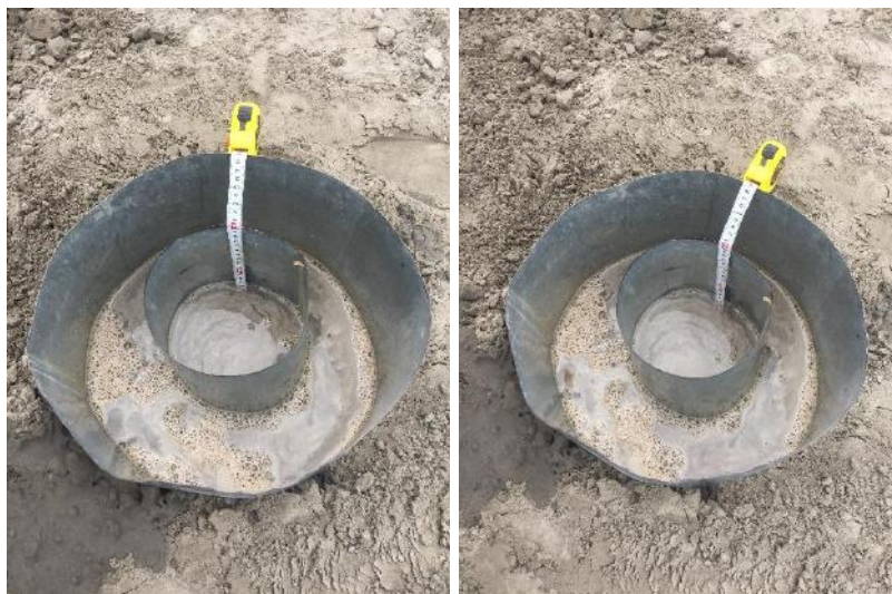
图 5.3.6-1 双环渗水实验现状照片
